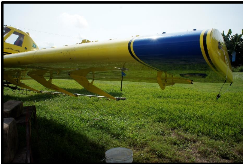
Fotografía No. 8 Ala izquierda con fuga de combustible.
