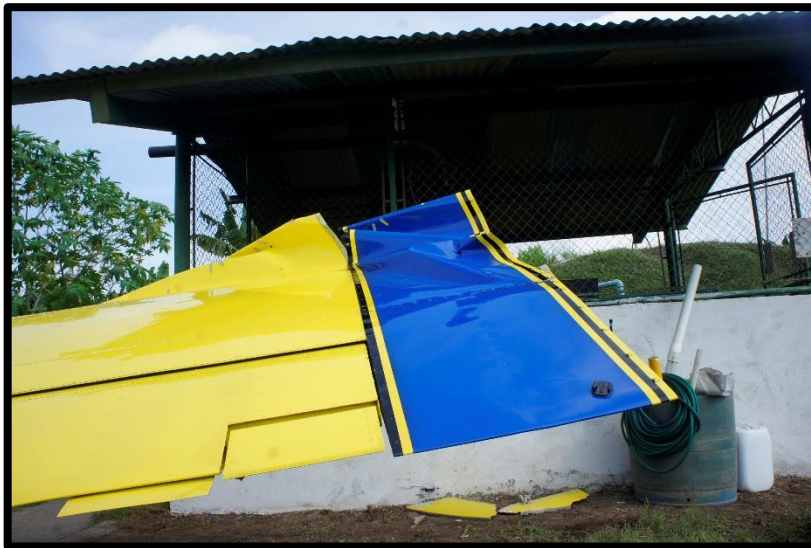
Fotografía No. 6 Vista por detrás del golpe en punta del ala.
