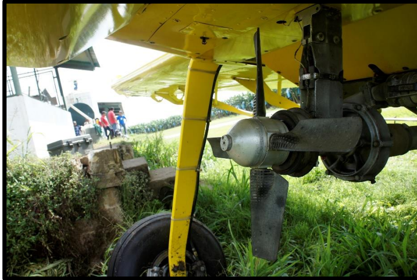
Fotografía No. 11 Tren de aterrizaje derecho, sin daños.
