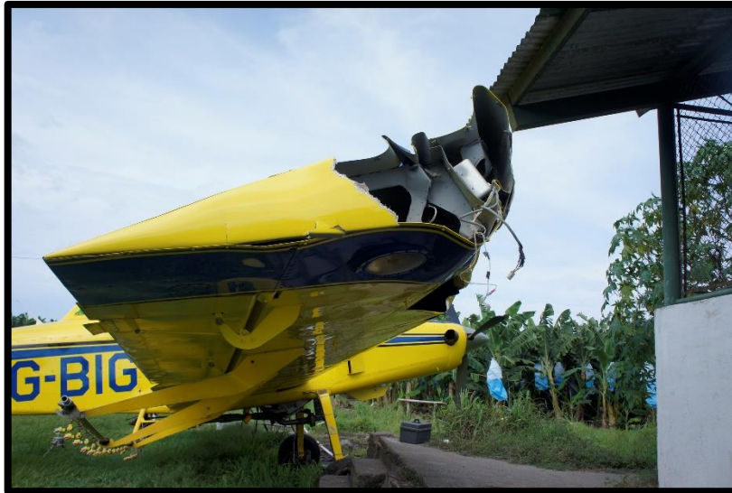
Fotografía No. 3 Golpe en la punta del ala derecha.
