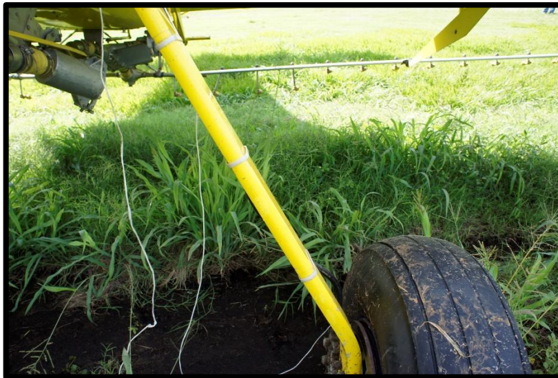
Fotografía No. 10 Tren de aterrizaje principal izquierdo, sin daños.
