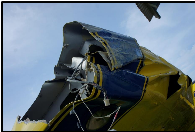
Fotografía No. 4 Vista cercana del golpe en punta del ala.
